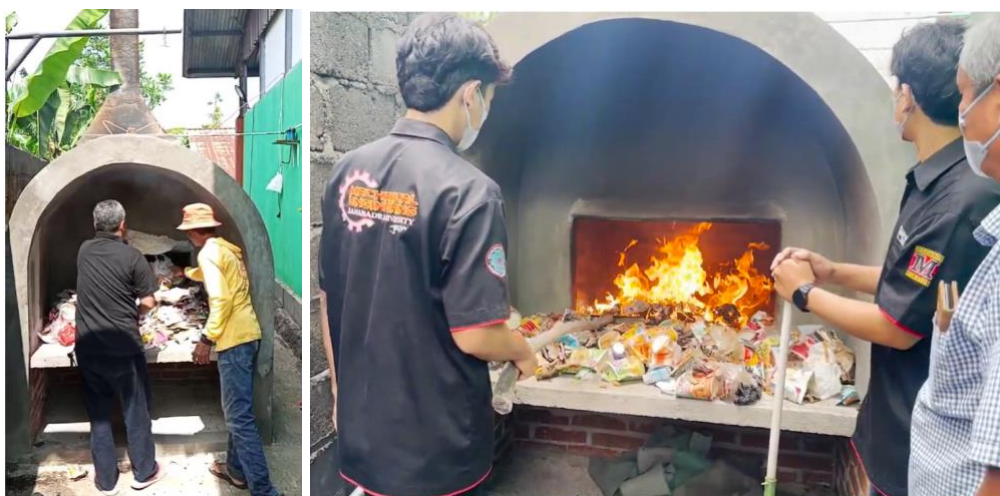
Gambar 5. Uji coba alat pembakar sampah
