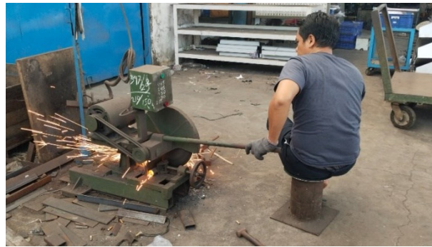
Gambar 2. Pekerja Tidak Memakai APD Saat Menggerinda
